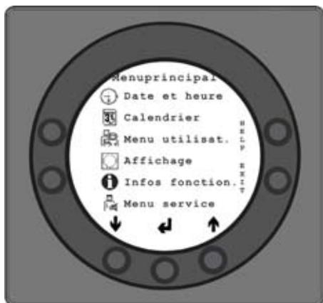
Les boutons de commande changent de fonctions. En appuyant sur « Flèche bas » ou « Flèche haut », le symbole devient une flèche horizontale, qui indique la situation actuelle.
